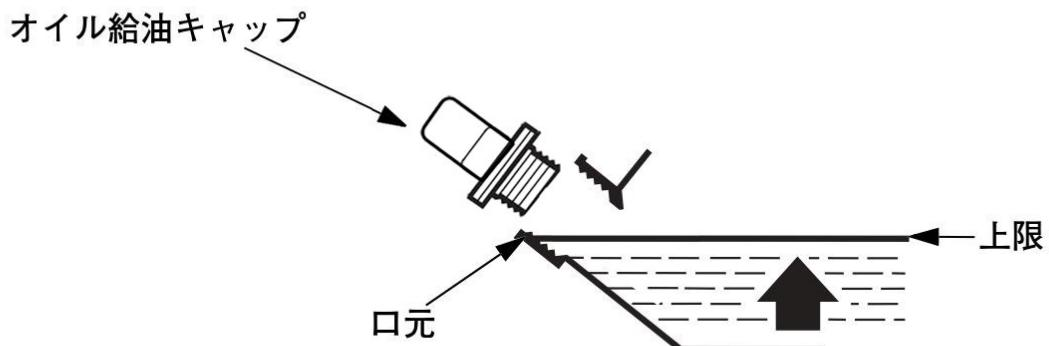
10. 注入後、オイル給油キャップをゆるまないように確実に締付けます。
