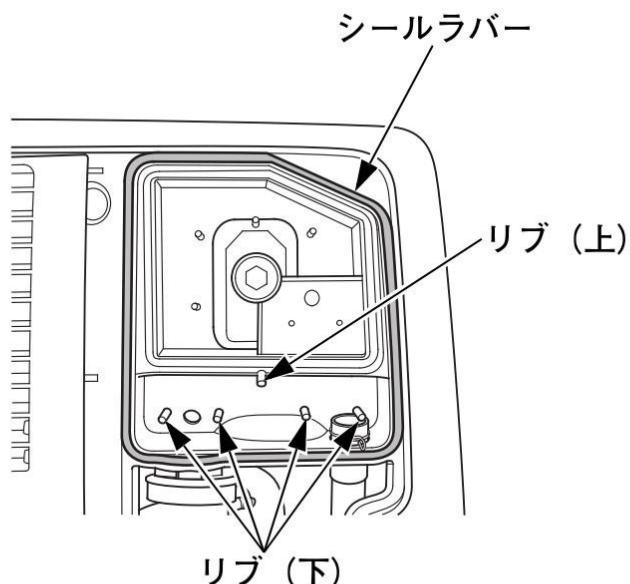
3. 本機側のシールラバーに損傷がないこと、また確実に取付けられていることを確認します。
