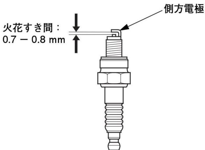
6. 取付けはまず手で一杯までねじ込み、次に同梱の専用点火プラグレンチで確実に締付けます。
